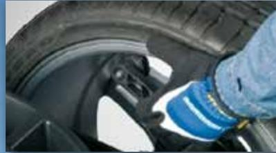
Los mecánicos no tienen más que tocar la llanta con el brazo calibrador, y el sistema introduce automáticamente las dimensiones de la llanta y selecciona el modo de equilibrado de peso adecuado.
